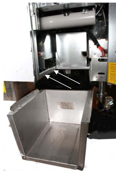
Obrázek 1: Pozice tajícího jednotku ve skříní a připojit pomocí šroubů do vnitřku skříňky.
